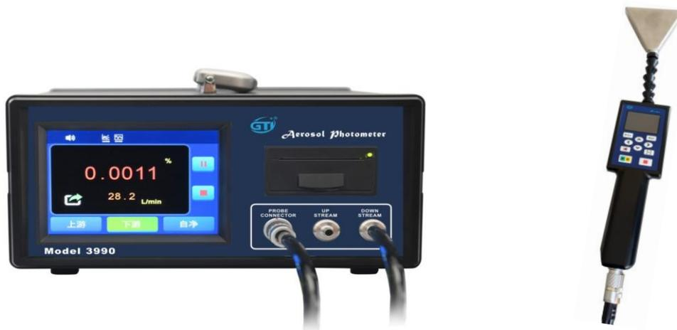
3990 是一款技術先進、設計科學的光散亂式線性數位氣溶膠光度計，是檢測高效過濾器完整性或洩漏試驗必須採用的最佳測試儀器。結構緊湊、攜帶方便、操作設置均可在 5.6inch 的真彩色觸控式螢幕，因具有氣溶膠雜訊抑制功能，測試資料更加穩定。內置熱感印表機並配有長效熱感打印紙，測試現場即可完成測試資料的即時列印。
