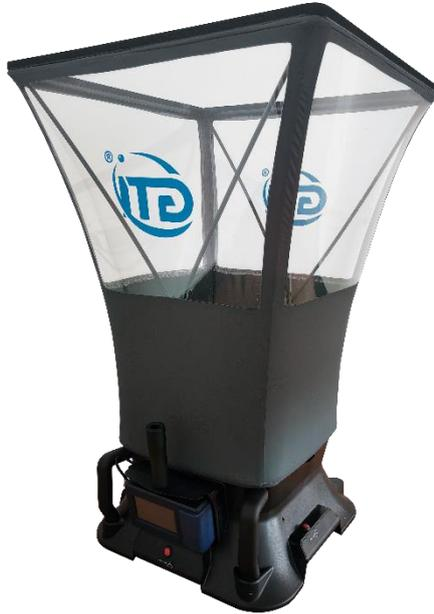
GTI620 型風量罩是集風量測試、風速測試、微差壓測試於一體的智慧型測試儀器，其廣泛適用於空調、管道等場所的風速風量測試，並且可以進行高精度的微差壓測試。
